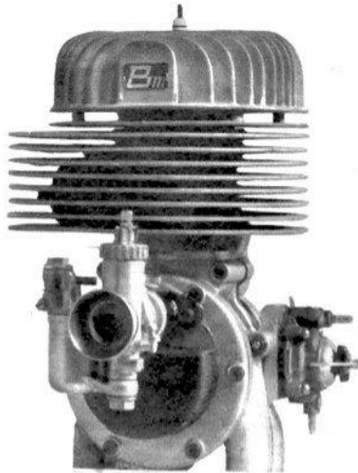
Corsa: 60 mm.; Alesaggio: 56 mm.; Alesaggio massimo: 65 mm.; Cilindrata: 147,8 cc.
